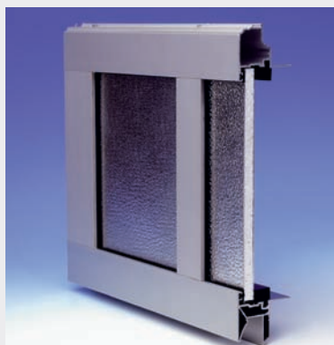
Lekka, ale stabilna: konstrukcja ramowo-szprosowa z wytłaczanych profili aluminiowych łączonych śrubami. Powierzchnia profili, odporna na działanie czynników atmosferycznych, anodowana jest w kolorze E6/EV1
