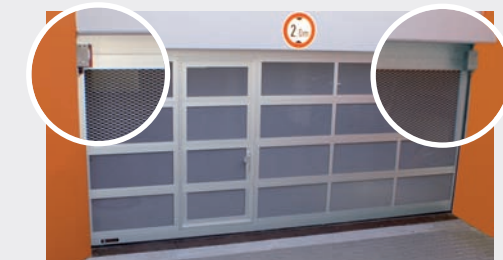
Zabezpieczenie przed wciągnięciem Zapobiega podniesieniu bramy w przypadku włożenia rąk np. do krat rolowanych. Brama w takim przy- padku automatycznie się zatrzymuje.
