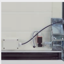
Optyczno-elektroniczna dolna listwa kontaktowa Brama zatrzymuje się natych- miast po najechnięciu na prze- szkodę i cofa się kawałek z powrotem do góry.
