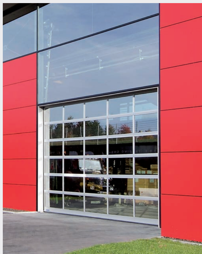
Lekka, ale stabilna: konstrukcja ramowo-szprosowa z wytłaczanych profili aluminiowych łączonych śrubami. Powierzchnia profili, odporna na działanie czynników atmosferycznych, anodowana jest w kolorze E6/EV1
