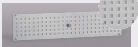
Aluminiowa blacha wentylacyjna z zasuwą otwór prostokątny 7 mm, wymiary: 400 x 90 mm zamykana od wewnątrz, przekrój wentylacyjny: 63,7 cm 2
